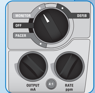
Impostazioni dei regolatori per il monitoraggio con la R Series
